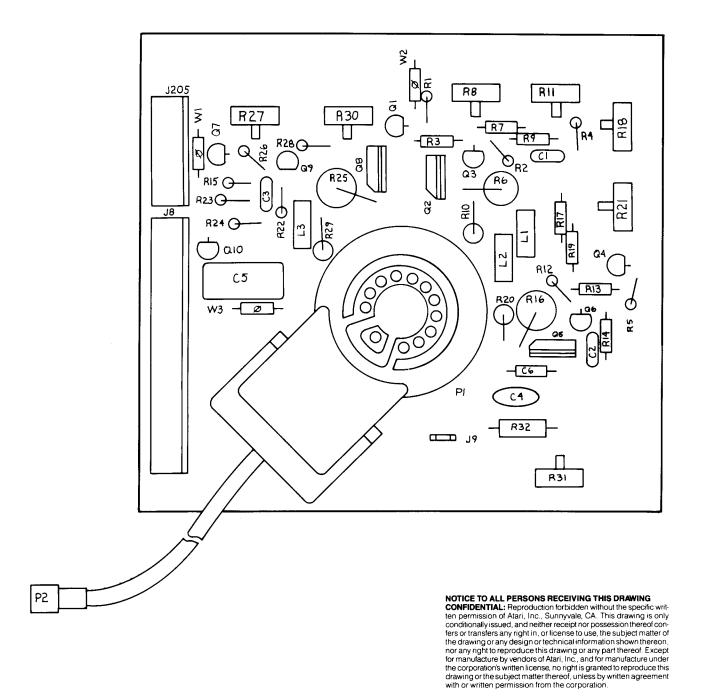
Figure 6-5 Neck PCB Assembly 19-Inch Display A201020-01 B 25-Inch Display A201020-03 A
